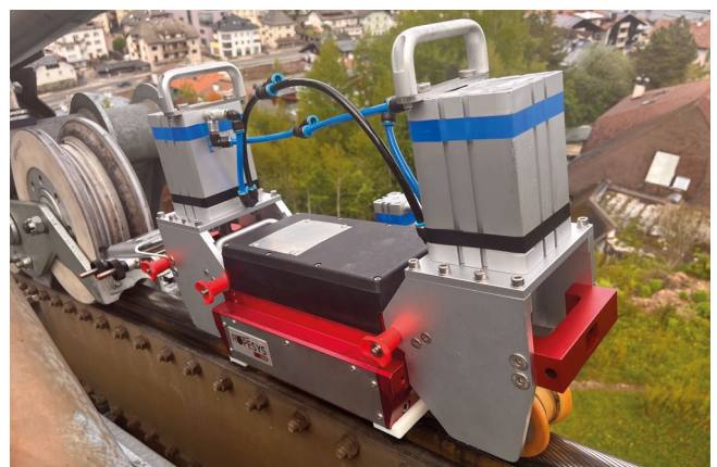
Tragseilprüfung mit pneumatischer Abhebevorrichtung Track rope inspection using with pneumatic lifting device
