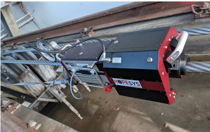
Kombinierte Seilprüfung: Magnetisch & visuell Combined rope testing: Magnetic & visual
